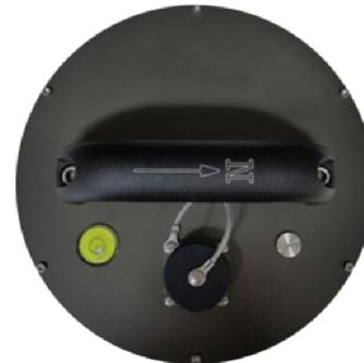
Sismómetro triaxial de banda ancha, capaz de detectar movimientos pequeños por el precio y el tamaño de un instrumento para la detección de movimientos medianos.
